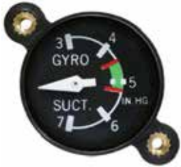
UMA 1-1/4" GYRO SUCTION GAUGES Case: Molded ABS Plastic. Weight: 1.4 oz.
